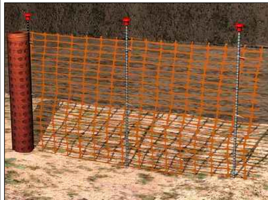
MALLA DE SEÑALIZACION LIMITE DE RELLENO
